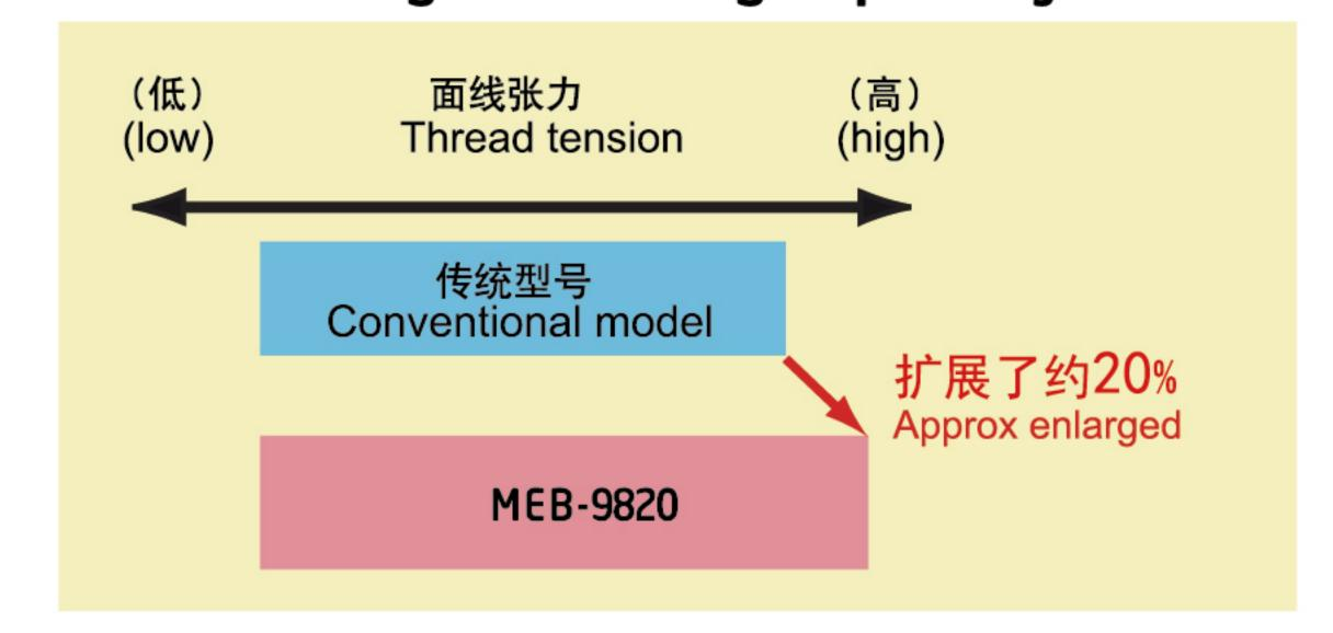
3.0mm宽度之字缝,缝纫后裁剪。2块聚酯哔叽(其中一块的一侧有夹层)纺线 #40,底线张力: 30g, 传统型号 -2,200针/分钟, MEB-9820 -2,500针/分钟
